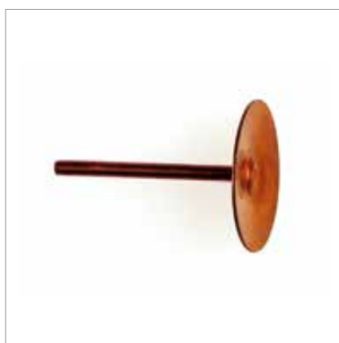
Kobber stormklamme. Anvendes hun til 300 x 600 mm skifer ved stående montage samt til 400 x 400 mm skifer i begge montage varianter.
