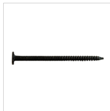
Indfarvet skifer søm. Anvendes kun hvor det er nødvendigt at sætte et synligt søm i facaden (normalt kun ved afslutninger).
